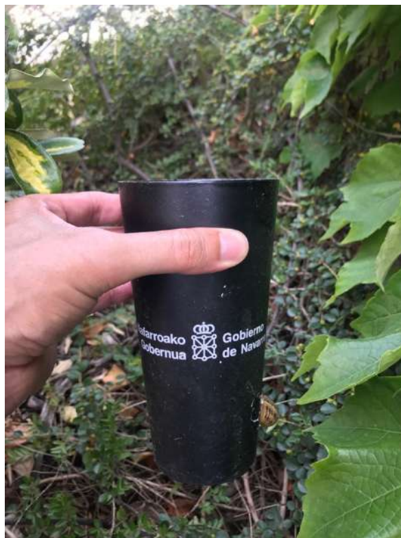
Trampa de oviposición empleada para la vigilancia del mosquito tigre en Navarra
