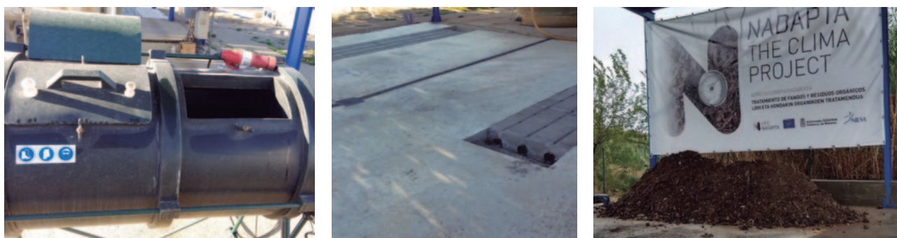
Figura 1. Instalaciones de compostaje utilizadas. De izquierda a derecha: reactor automático; sistema de aireación para pila estática aireada; pila volteada
