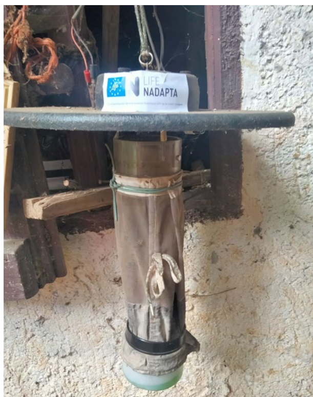
Imagen 2. Trampa de aspiración y luz UV para culicoides.
