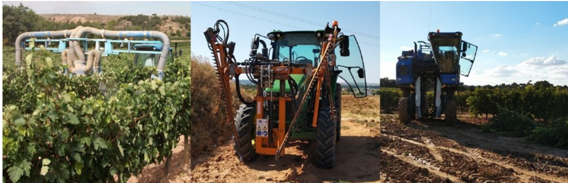
Figura 8: El empleo de maquinaria en la viticultura moderna es cada vez mayor, siendo ésta además más especializada según la labor a realizar. De izquierda a derecha, maquinaria para la aplicación de un tratamientos fitosanitarios, para la realización de despuntes y para vendimiar.
