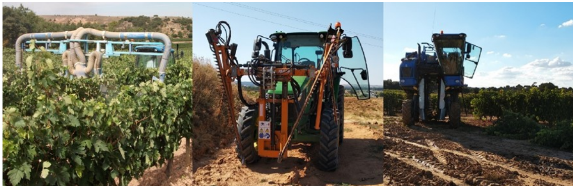
Figura 8: El empleo de maquinaria en la viticultura moderna es cada vez mayor, siendo ésta además más especializada según la labor a realizar. De izquierda a derecha, maquinaria para la aplicación de un tratamientos fitosanitarios, para la realización de despuntes y para vendimiar.
