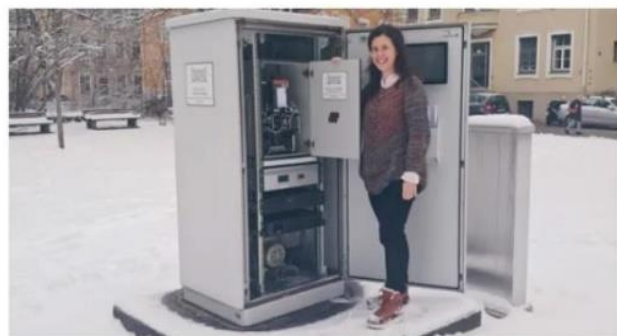
La investigadora Mónica González Alonso, junto al BAA500 (Bio Aerosol Analyzer), aparato que toma muestras de aire, les hace fotos, y cuenta y clasifica el polen que hay en ellas de manera automática.
