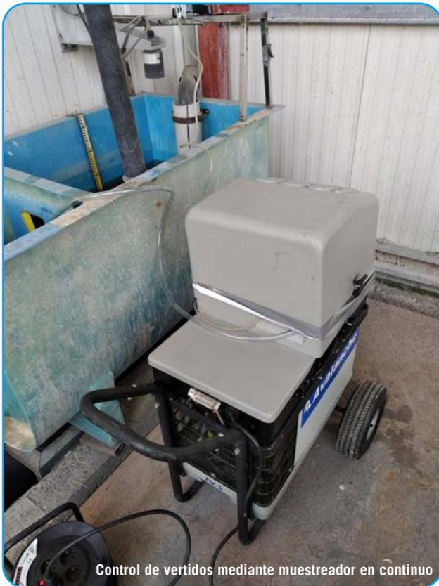
Control de vertidos mediante muestreador en continuo
