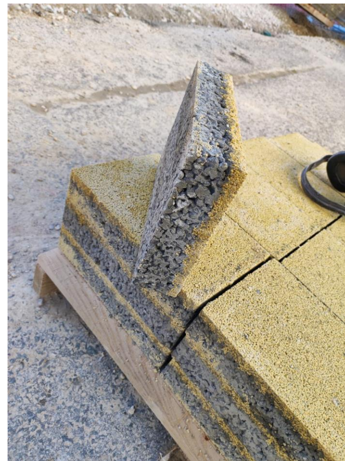
Hormigón de alta capacidad drenante
