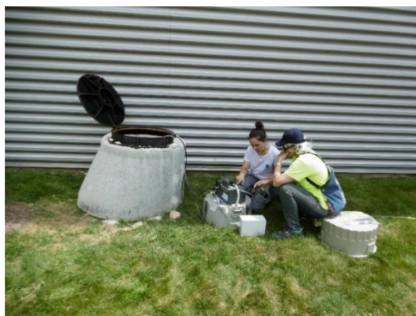
Figura 5 Cono para proteger el tomamuestras, situado próximo al pozo de registro de aguas pluviales definido como punto de control.
