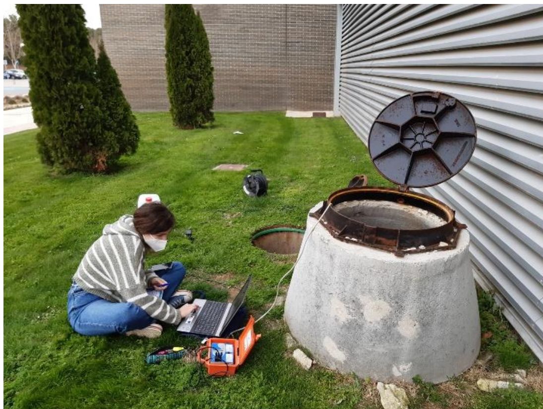
Figura 35 Adquisición de datos de caudal mediante un caudalímetro portátil en el aparcamiento de la UPNA de Tudela.
