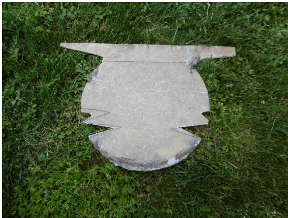
Figura 1 y Figura 2. Impedimento instalado para permitir la toma de muestras en el colector de pluviales
