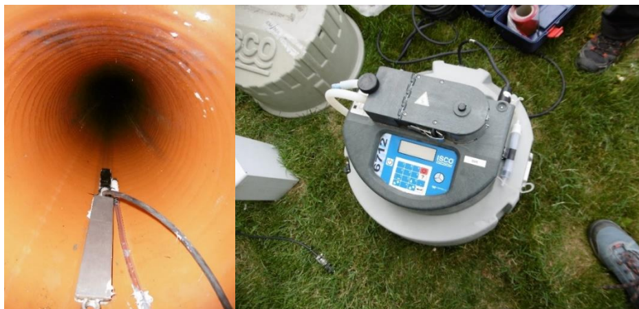
Figura 3 y Figura 4. Caudalímetro de canal abierto y tomamuestras portátil automático con batería [ISCO 6712]
